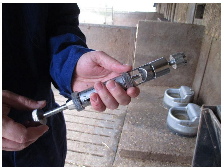
Billede 5.1: Pillestyrketester benyttet i afprøvningen
