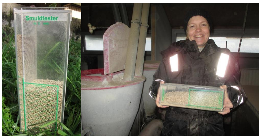
Billede 2.1. Smuldtester benyttet i afprøvningen.
