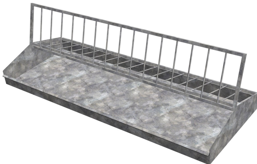
Figur 9. Skitse af langtrug med gittermontering. Truget løftes ikke fra jorden i et forsøg på at forhindre rotter i at gemme sig. Løfteanordning i den øverste del er ikke illustreret/opfundet endnu. Illustration af Kent Laursen.
